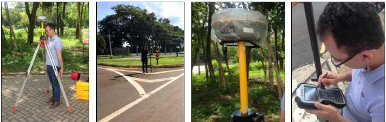
Figura 77. Sequência de operações de campo para a ortorretificação das imagens de satélite Fonte: Propark, 2019.
